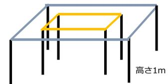
鉄ピンとPPロープで枠組み
