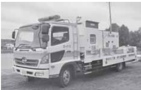
排水ポンプ車
