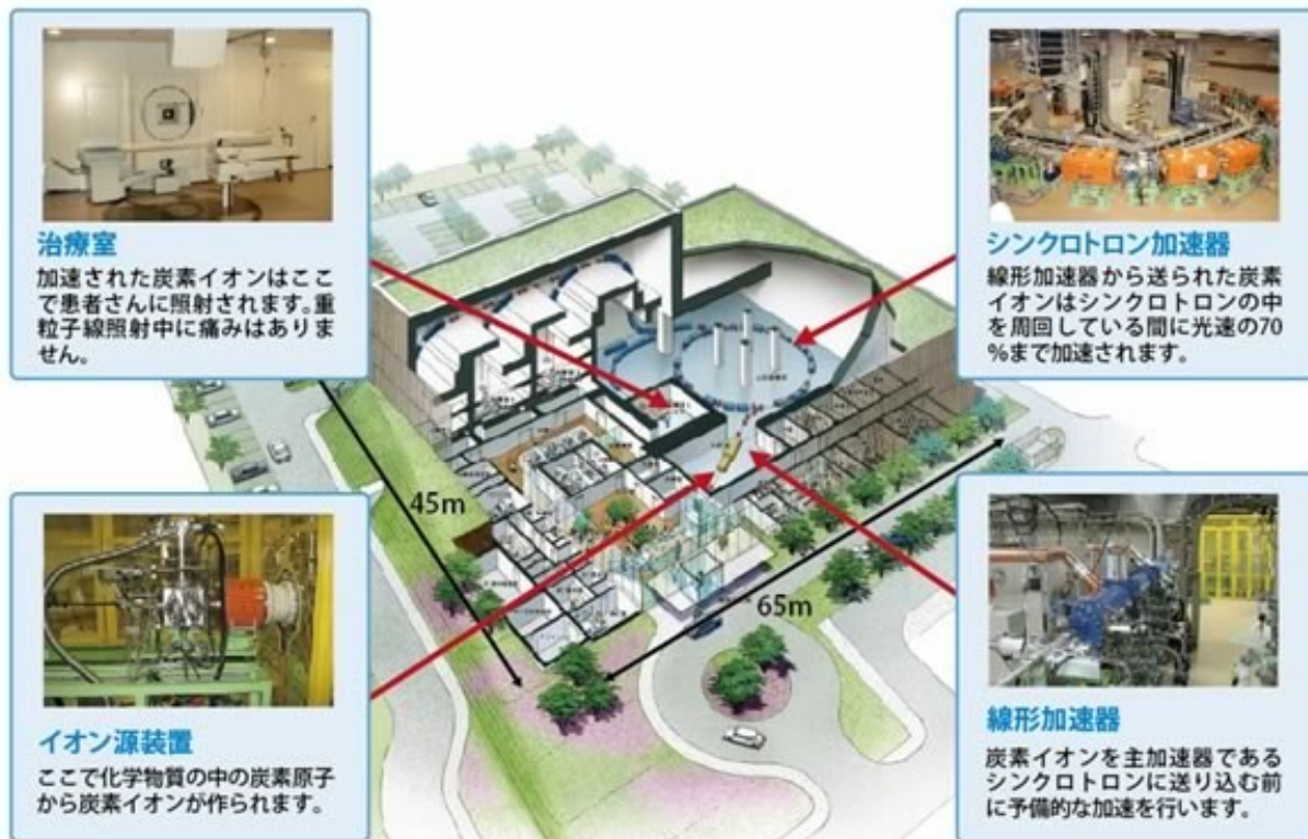
図6. 小型化された普及型照射施設－群馬大学
